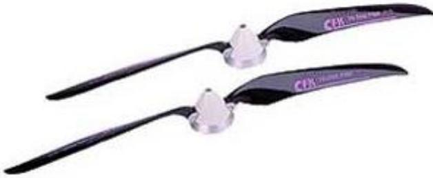
Hochwertige Klappflugschraubenserie. In Handarbeit hergestellt. Speziell für enorm hohe Belastungen in Verbindung mit Hochleistungsantrieben konzipiert. Für Brushlessmotoren mit Wellen-Ø 6 mm. Extrem torsionssteif durch diagonal eingelegtes Körper-Kohlefasergewebe. Hohe Drehzahlfestigkeit durch eingelegte Kohlerovings Präzisionsnabenspule aus Aluminium Niedriges Gewicht durch hohen Kohlefaseranteil Polierte Klarsichtoberfläche.
