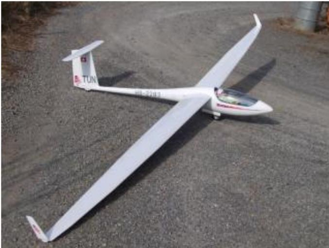
Modell im Massstab 1:3 in voll GFK / CFK!
