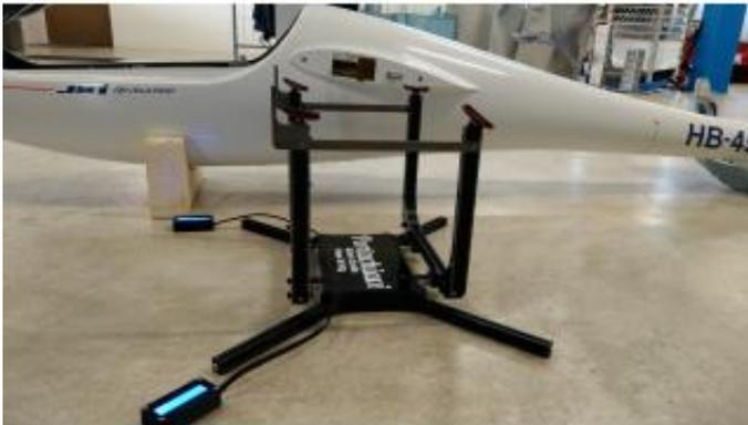
Diese Schwerpunktwaage ist sehr stabil gebaut, für Modelle bis 30kg!
