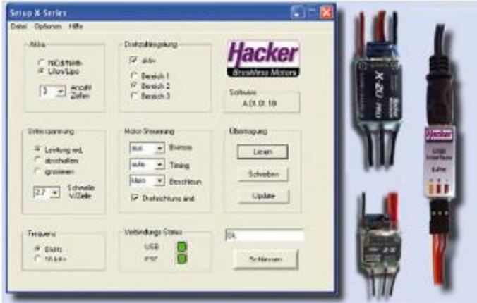
Wir bieten in Verbindung mit dem neuen USB-Interface eine große Anzahl von Einstellmöglichkeiten. Hier kann nicht nur die Zellenzahl sondern auch die Abschaltspannung kann wählen, wann der Steller eingreifen soll um den LiPoAkku vor zu tiefer Entladung zu schützen.
