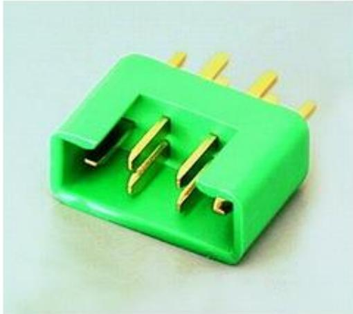
Verpolsicher, vielseitig, kompakt. Geeignet für Stöme bis 35 A (60 A für 30 sec), bei 2x3pol-Anschluss zwischen z.B. Antriebsakkus und Regler oder Antrieben oder für sonstige Steckverbindungen.
