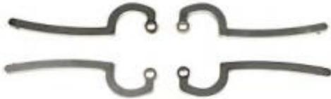
Durch die besondere Geometrie werden die Deckel beim Öffnen nach außen verschoben. Das hat den Vorteil, dass der Fahrwerksschacht schmaler bemessen werden kann, da die Deckel dem ausgefahrenen Rad nicht im Weg stehen. Die Deckel sind durch einfaches Herausziehen der Achse (nicht im Lieferumfang enthalten) abnehmbar.
