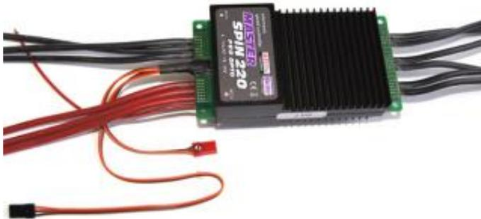
Die **Master Spin Pro** Reihe bietet gegenüber der bisherigen Master Spin Baureihe erweiterte Programmiermöglichkeiten, wie z.B. "AUTO-Timing" und die direkte Eingabe der Abschalt-/Abregelspannung um allen Anforderungen und Akkutypen gerecht zu werden.
