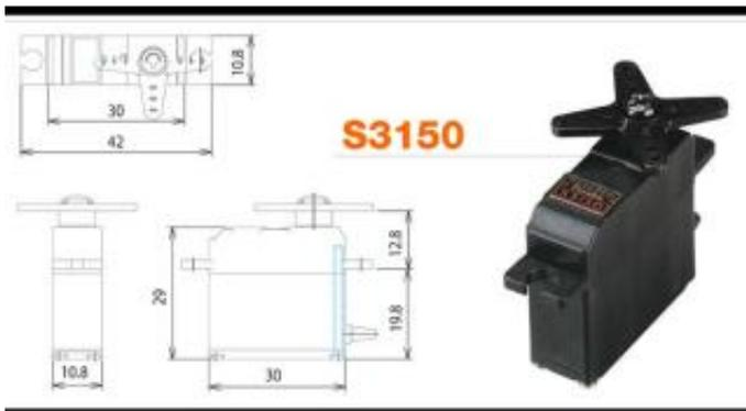
Das Digitalservo S 3150 DIGITAL der Nano-Baugröße mit dem sensationellen Kraftmoment von 46 Ncm bei nur 10,8 mm ´Dicke´. Das robuste 5-stufige Getriebe ist mit 4 Metallzahnradern ausgeführt, wobei 2 weit auseinander liegende Kugellager das Abtriebszahnrad hervorragend gegen Radialkräfte abstützen.
