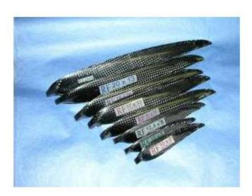
Handgefertigte CFK Klapppropeller
