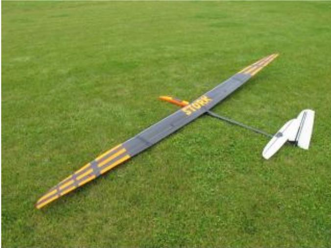
Der Stork 6 F3J ist ein neu entwickeltes Modell für die Thermikkategorie. Das Modell ist sehr leicht und doch stabil aufgebaut. Hat ein abnehmbares Seitenruder. Viele geniale Detaillösungen sind nach einigen Jahren der Weiterentwicklung eingeflossen. Es sind zwei verschiedene Ausführungen, mit V- oder Kreuzleitwerk verfügbar.
