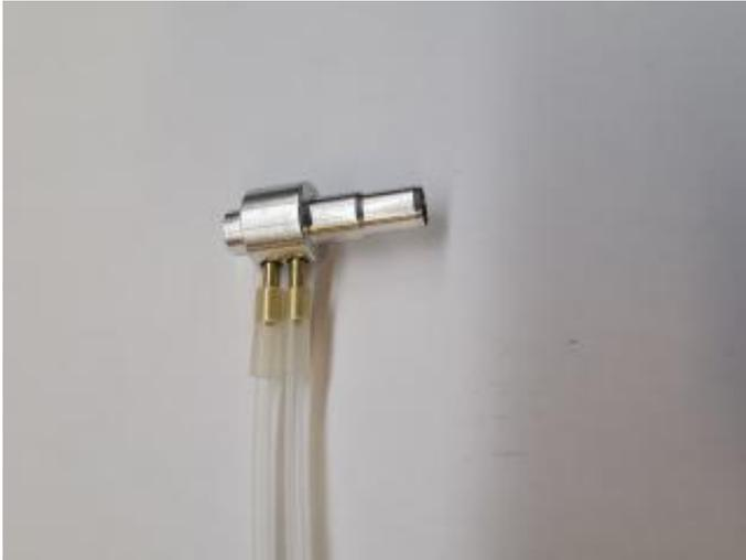
Die Halterung wird fest in das Leitwerk eingebaut und dient als Aufnahme für das Prandtl-Rohr. Das Prandtl-Rohr wird zum fliegen einfach in die Halterung gesteckt und dichtet automatisch. An die beiden Anschlüsse werden die Teflonschläuche angeschlossen welche bis ins Cockpit verlegt werden. Diese sind nach Maß extra zu beziehen.
