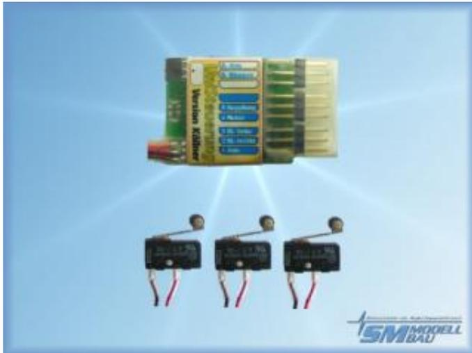
Für die komplett vollautomatische Ansteuerung von elektrischen Klapptriebwerken in Großseglern ohne Programmieradapter.
