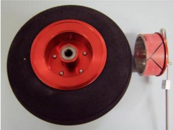
Kugelgelagertes Vollgummirad mit Trommelbremse für Scalesegler.
