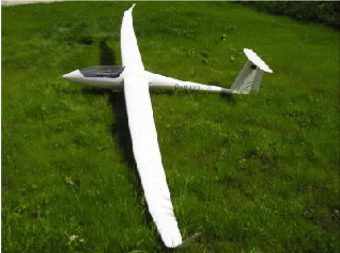
Der Ventus 2c ist eine völlig neue Konstruktion. Der Rumpf, der etwas länger und eleganter als der des alten Ventus ist, wurde nach neuen aerodynamischen Gesichtspunkten gestaltet. Auch die Tragflächen in doppelter V-Form wurden völlig neu entwickelt.
