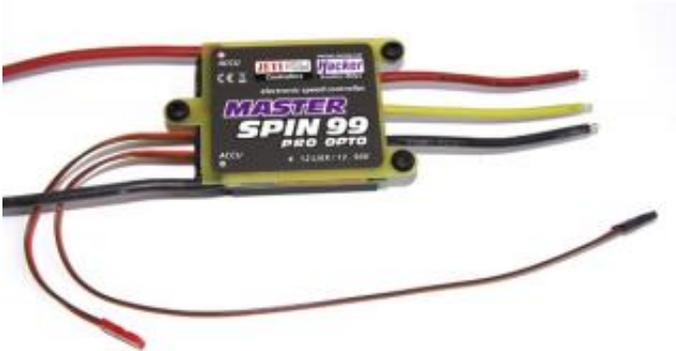
Die **Master Spin Pro** Reihe bietet gegenüber der bisherigen Master Spin Baureihe erweiterte Programmiermöglichkeiten, wie z.B. "AUTO-Timing" und die direkte Eingabe der Abschalt-/Abregelspannung um allen Anforderungen und Akkutypen gerecht zu werden.
