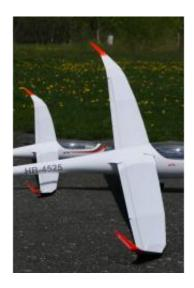
Die JS-2 wird im M 1:2.3 mit 7.8m Spannweite gebaut. Dies ergibt einerseits "kompakte Masse" aber auch ideale Rahmenbedingungen für die GPS SLS Klasse.
