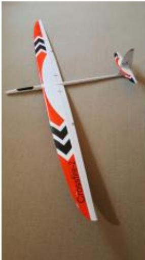
Gerade der Crossfire-2 ist mit der relativ großen Innentiefe des Flügels, dem langen Rumpfhebelarm und VLW-Größe prädestiniert für so eine F3J/F5J-Variante.
