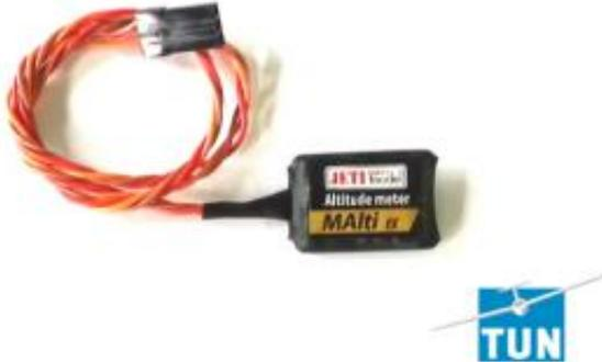
Das MAlti EX ist ein Sensor, der den atmosphärischen Druck misst. Aus den gemessenen Daten errechnet das MAlti EX die Höhe über NN und die relative Höhe über Grund.
