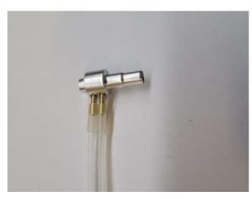
Die Halterung wird fest in das Leitwerk eingebaut und dient als Aufnahme für das Prandtl-Rohr Das Prandtl-Rohr wird zum fliegen einfach in die Halterung gesteckt und dichtet automatisch. An die beiden Anschlüsse werden die Teflonschläuche angeschlossen welche bis ins Cockpit verlegt werden. Diese sind nach Maß extra zu beziehen.
