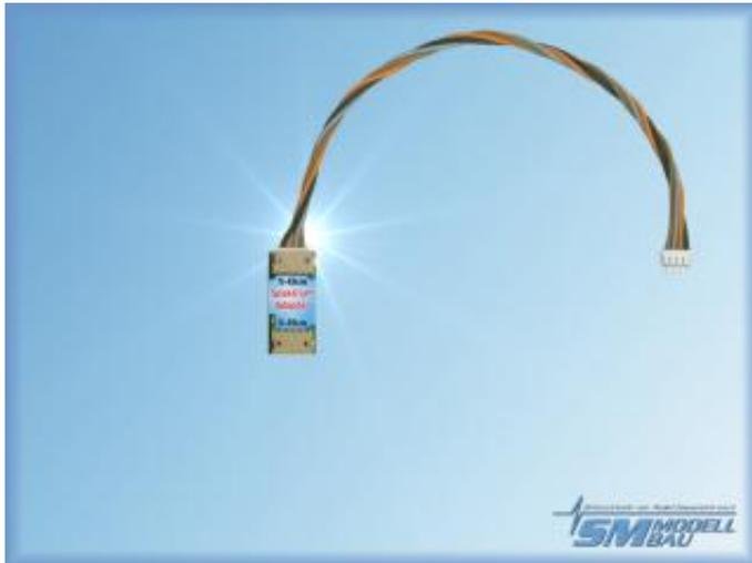
Adapterkabel für den Anschluss von UniSens-E, UniLog 2, GPS-Logger 1-3 und MicroVario an die Spektrum Telemetrie. Übersetzt die Daten der Sensoren in das Spektrum X-Bus Format.
